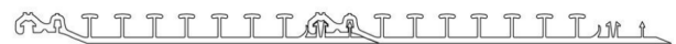
图 3 固定型带状型材剖面结构（双锁扣） Fig. 3 Fixed diameter profile structure (double lock)
